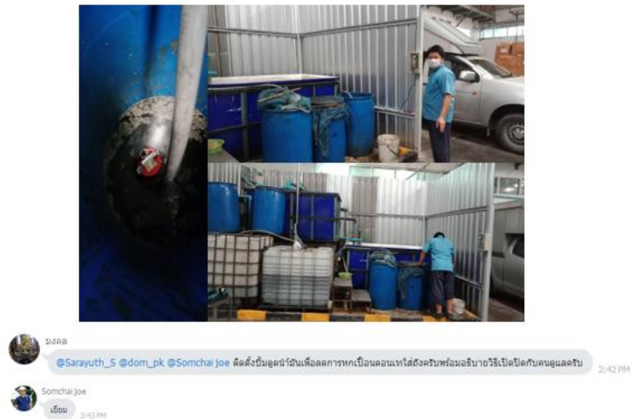
ภาพที่ ๔.๑๔ : การแจ้งข่าวสารในกลุ่มโปรแกรม Line การติดตั้งปั๊มดูดน้ำมัน เพื่อลดการหกปนเปื้อนที่ทำให้เกิดปัญหาน้ำเสียในโรงงานเก่าแก่อ้อยฯ ๑๕๙
